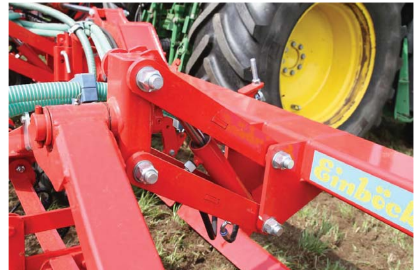
Abbildung 24: Parallelogramm mit Hydraulikzylinder
