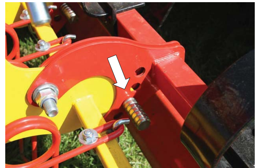
Abbildung 9: Einstellung der Arbeitstiefe des Streifbleches
