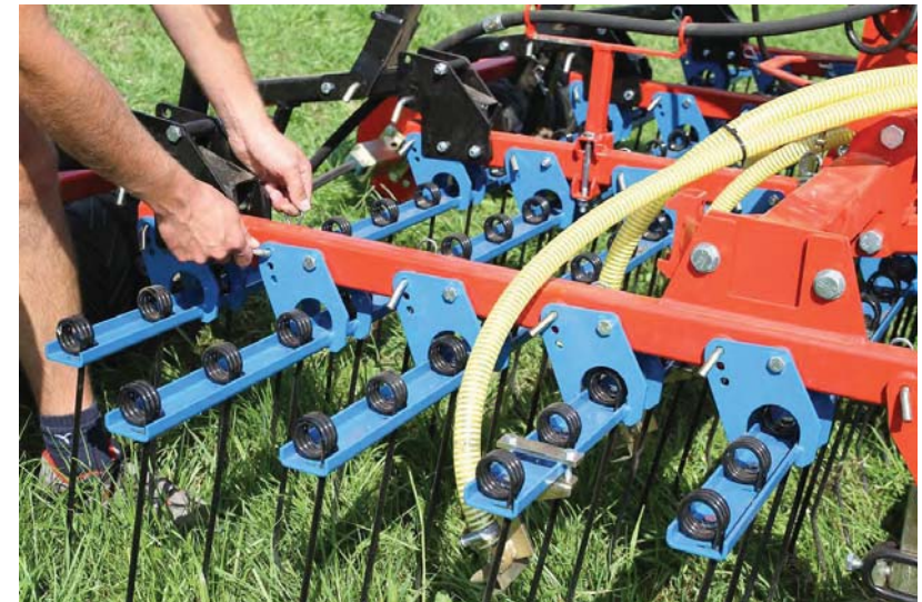
Abbildung 26: Einstellung der Aggressivität der Zinken
