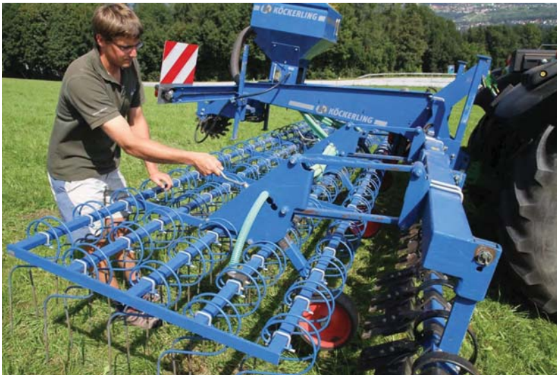
Abbildung 13: Einstellung der Arbeitstiefe der Zinkenfelder über das Tastrad
