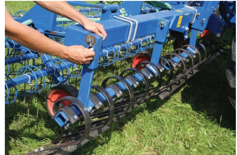
Abbildung 14: Höhenverstellung vom Einebnungsstreichblech
