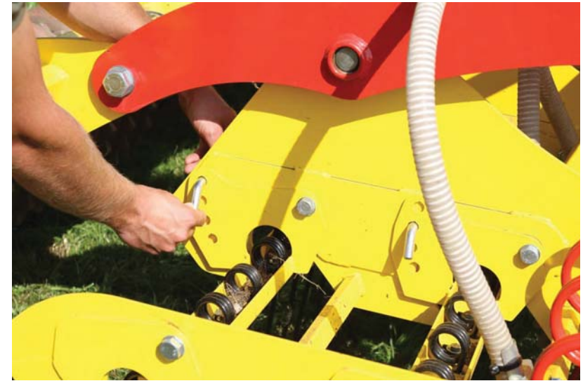
Abbildung 8: Einstellung der Aggressivität der Schwachzinken
