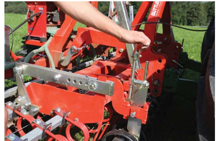
Abbildung 19: Einstellung der Arbeitstiefe des Ripperbords
