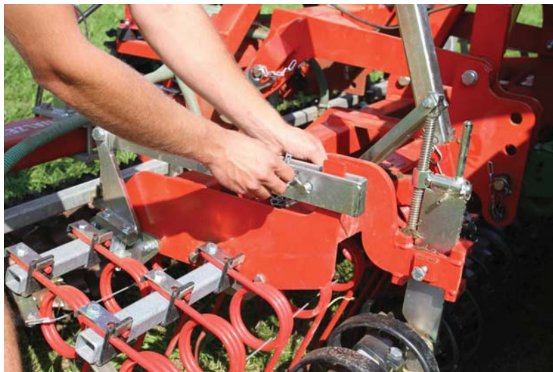
Abbildung 18: Einstellung der Aggressivität der Zinken
