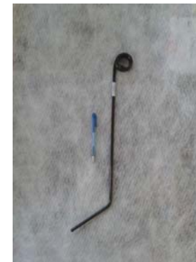
Abbildung 40: 8mm Zinken von Hatzenbichler
