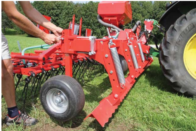
Abbildung 22: Höheneinstellung der Trasträder
