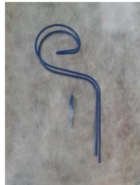
Abbildung 37: 8mm Zinken von Köckerling
