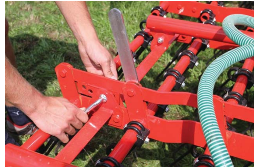
Abbildung 23: Einstellung der Aggressivität der Zinken
