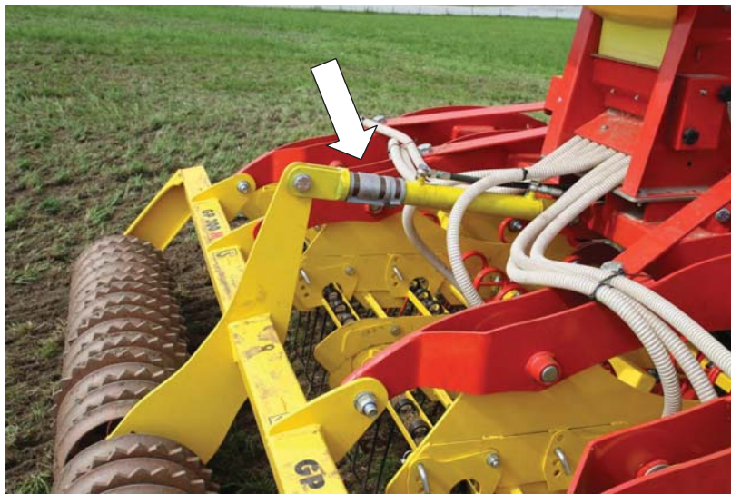
Abbildung 10: Hydraulikstempel mit Abstandhalter für Einstellung des Zinkenaufgedruck
