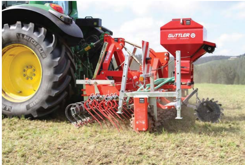
Abbildung 15: Der Güttler Grünlandstriegel mit Prismenwalze im praktischen Arbeitseinsatz
