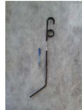
Abbildung 38: 8mm Zinken von Einböck
