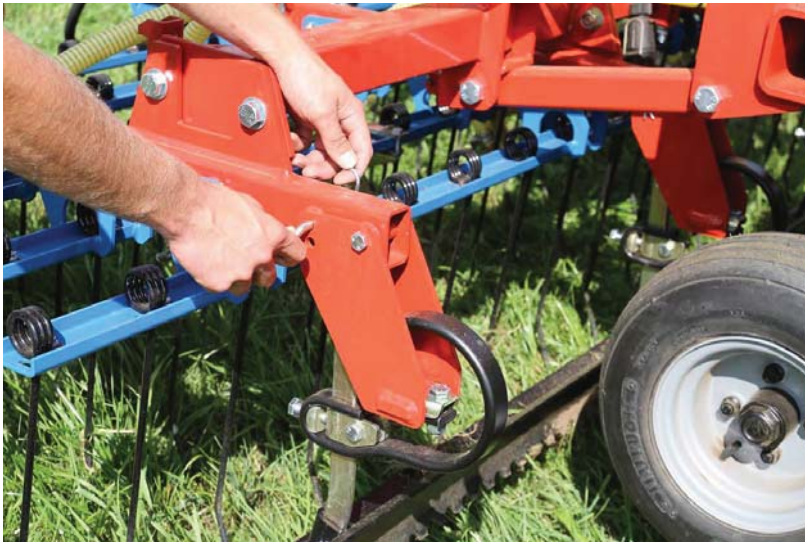
Abbildung 27: Einstellung der Aggressivität des Streichblechs
