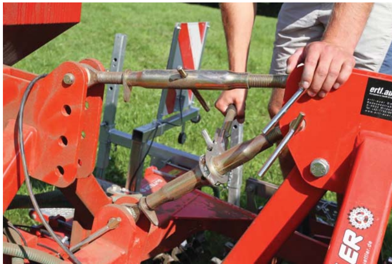
Abbildung 17: Der untere Oberlenker dient zur Einstellung der Arbeitstiefe der Zinken, der obere dient zur Einstellung des Auflagedrucks.
