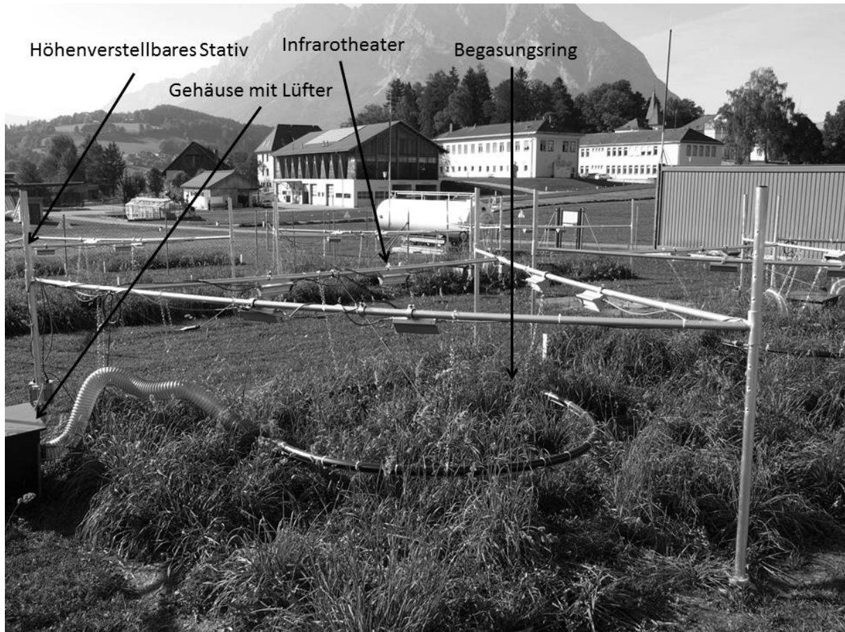
Abb. 3 Versuchspazelle mit Aufbau zur Begasung und Beheizung (Foto: M. Kandolf)
