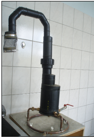
Abbildung 5: Selbst konstruierte Wurzelwaschanlage
