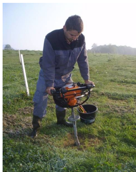
Abbildung 4: Selbst angefertigter Bohrer zur Entnahme von Bohrkernen für die Wurzelmassebestimmung
