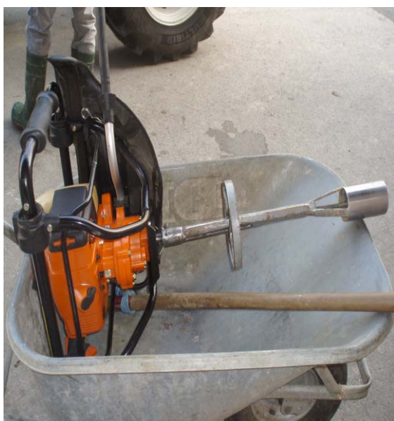
Abbildung 4: Selbst angefertigter Bohrer zur Entnahme von Bohrkernen für die Wurzelmassebestimmung
