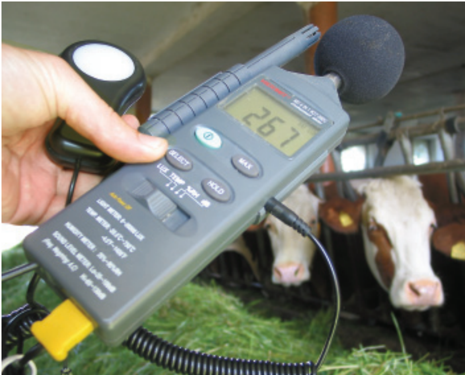
Empfindliche Beleuchtungsmesser (Lux-Meter) decken Schwachstellen rasch auf.
