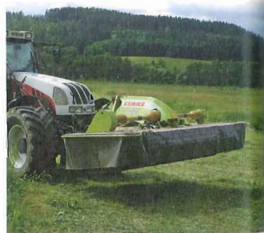
Claas DISCO: Niedrigste Vorderachsbelastung durch geringes Gewicht und geringem Abstand zur Vorderachse.
