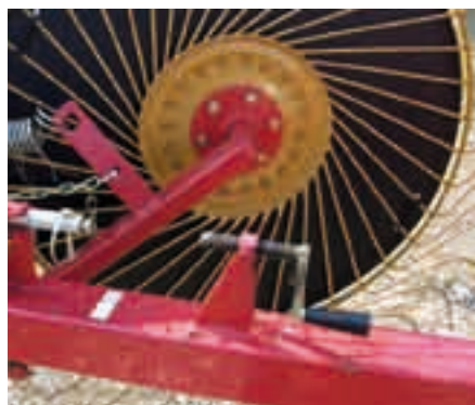
Le réglage de la pression des dents sur le sol se fait des deux côtés au moyen d'une manivelle.
