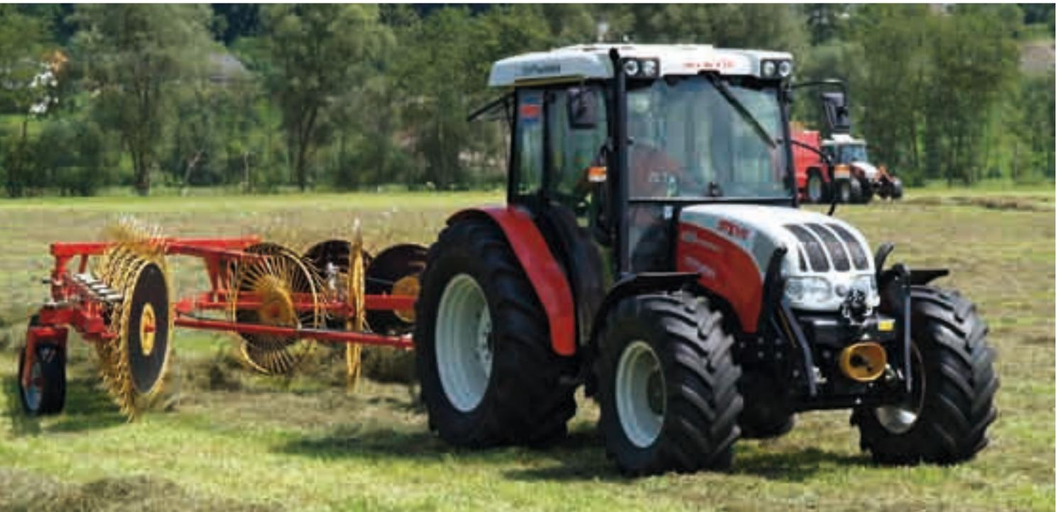
Der Sternradschwader mit Mittelablage schafft auf ebenen Flächen mit geringem Zugleistungsbedarf eine hohe Flächenleistung. Die Schwade wurden luftig und locker abgelegt. (Fotos: Pöllinger)
