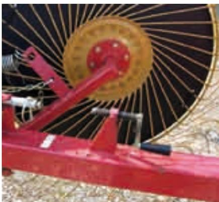
Der Zinkendruck auf den Boden wird auf jeder Seite mit einer Kurbel eingestellt.
