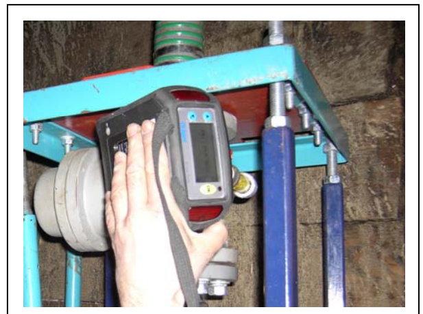
Abb.15: DrägerSensor® Smart CATEx – 68 10 410
