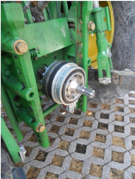
*Abbildung 14:* Am Zapfwellenstummel montierte Leistungsmessnabe (VASOLD, 2012)
