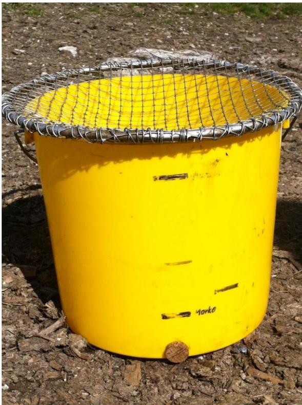
*Abbildung 18:* Eimer mit Sieb zur Viskositätsbestimmung (VASOLD, 2012)
