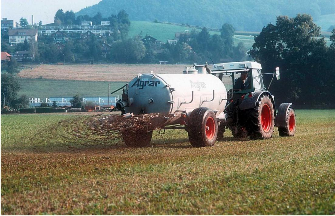
Abbildung 6: Kontinuierliche Ausbringung mit Gülledruckfass
