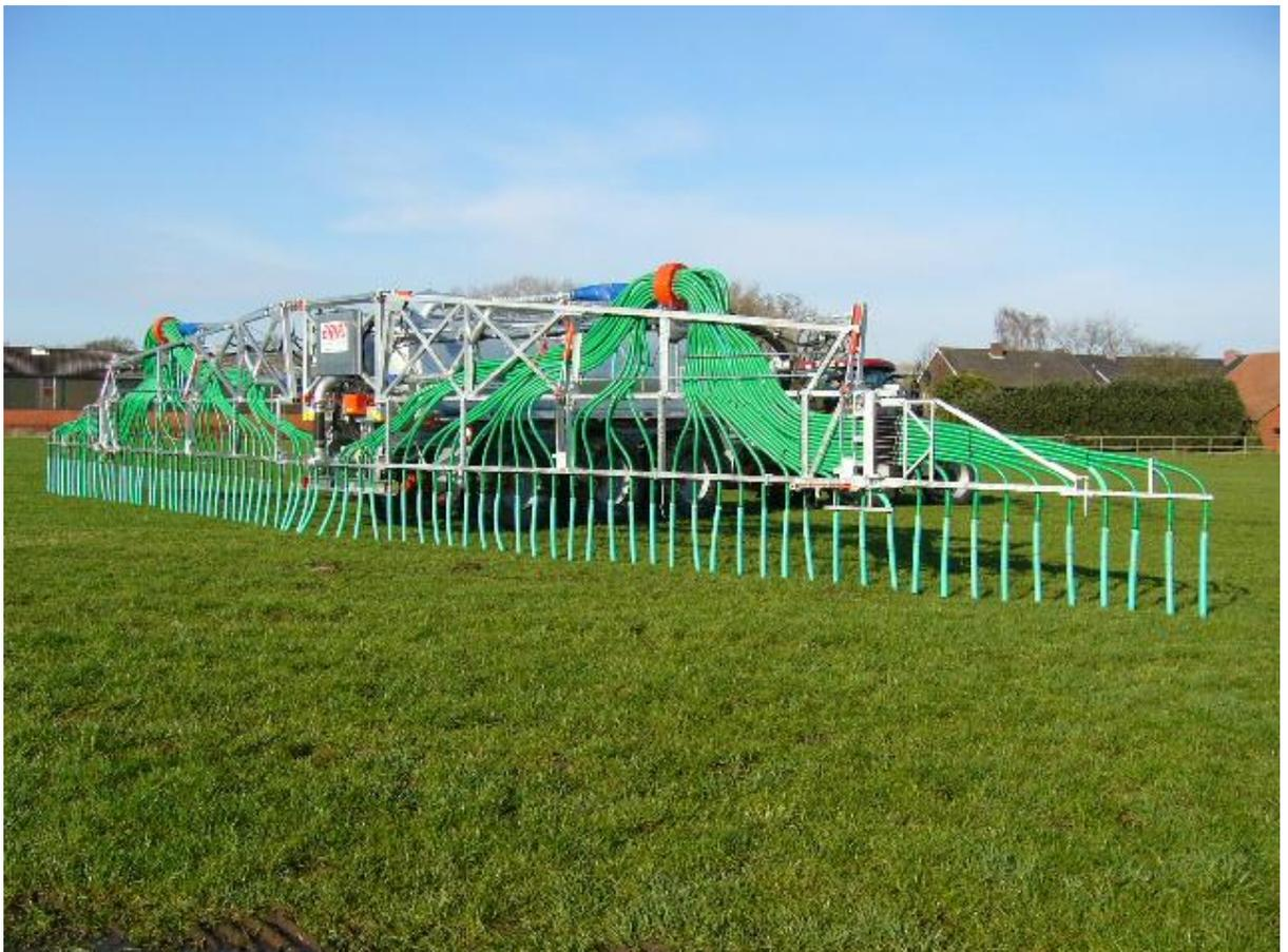
Abbildung 12: Schleppschlauchverteiler (www.briri.de, 2012)
