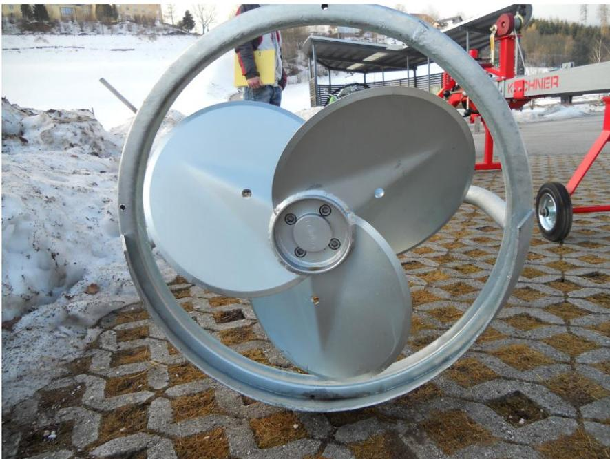
Abbildung 20: Rührflügel der Firma Bauer (VASOLD, 2012)
