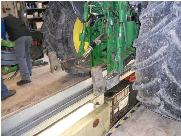
*Abbildung 15: Am Traktor montierte Ober- und Unterlenker zur Datenerfassung (VASOLD, 2012)*
