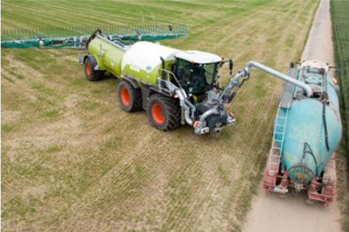
Abbildung 7: Befüllung eines Selbstfahrers beim absätzigen Gülleausbringungsverfahren (www.claas.de, 2012)
