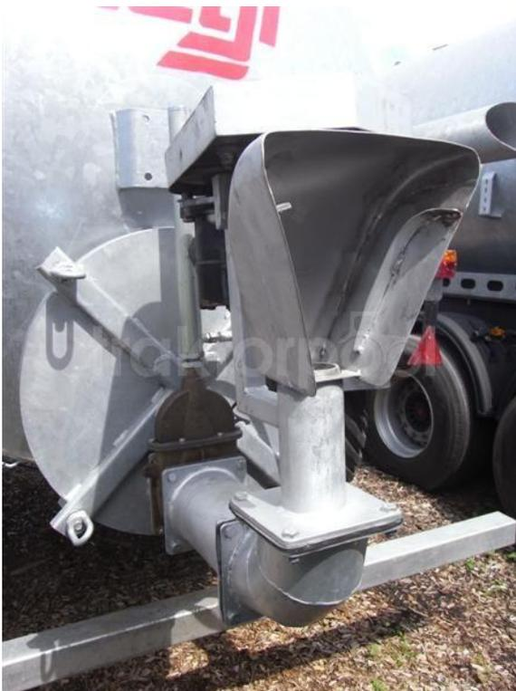
Pendelverteiler besitzen laut PÖLLINGER und PÖTSCH (2000) ein hin und her bewegendes Verteilorgan. Der Antrieb erfolgt entweder über die Traktorhydraulik, elektrisch oder direkt über den Güllestrom. Die Änderung der Bewegungsrichtung erfolgt durch zwei Anschlagbolzen an der Außenseite.
