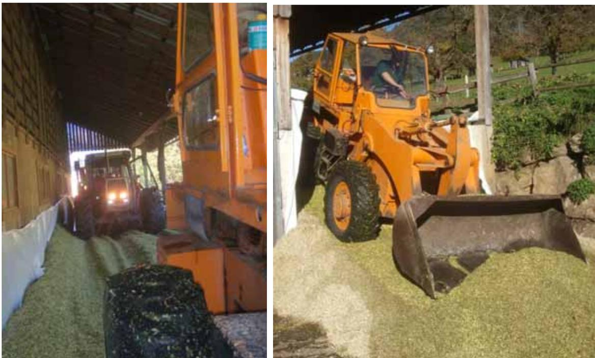
Abbildung 5: Verdichtung des Fahrsilos mittels Hoflader (Eigenfotografie, 2010)
