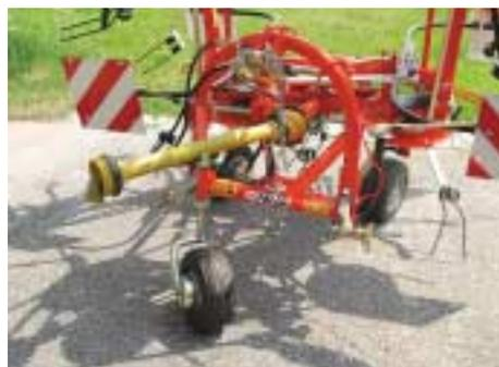
Einige Hersteller bieten auf Wunsch ein zusätzliches Tastrad zur Verbesserung der Bodenanpassung mit einem Kettenoberlenker an. Es erleichtert auch den An- und Abbau an den Traktor.
