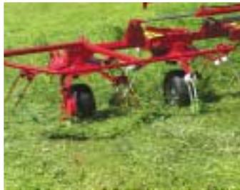
► **Die Grenzstreueinrichtung gibt es derzeit nur als Einzelradverstellung. SIP arbeitet bereits an einer hydraulischen Lösung.**
