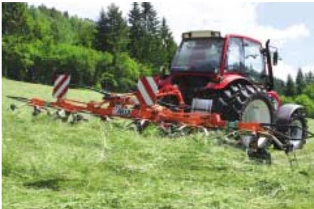
▶ Der Testkreisler von Fella war mit Tastrad und hydraulischer Grenzstreubetätigung ausgestattet.
