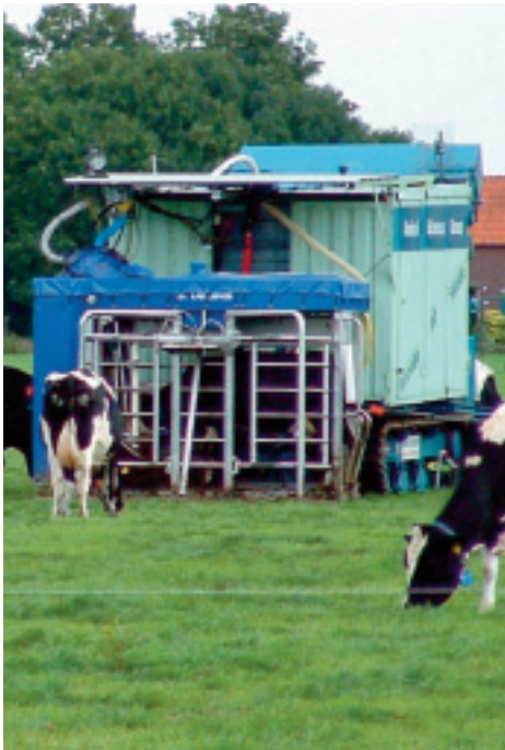
Mobiler Melkroboter auf der Weide: Eine Baggerraupe ausgerüstet mit Melktechnik, Milchtank, Wassertank, Kraftfutter und Stromaggregat machen den Melkroboter autonom.
