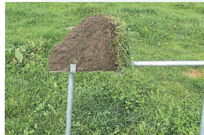
Abbildung 11: Mit einem Flachspaten entnommener Bodenziegel
