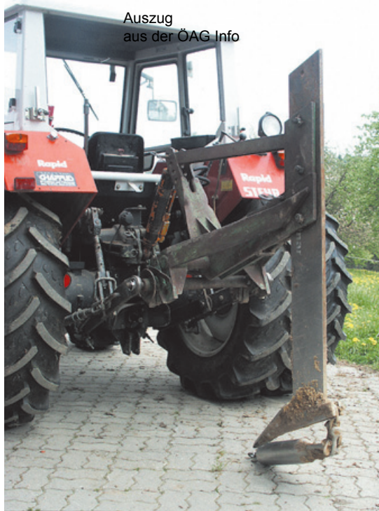
Mit einem Maulwurfspflug lassen sich Wasserleitungen sehr rasch verlegen.
