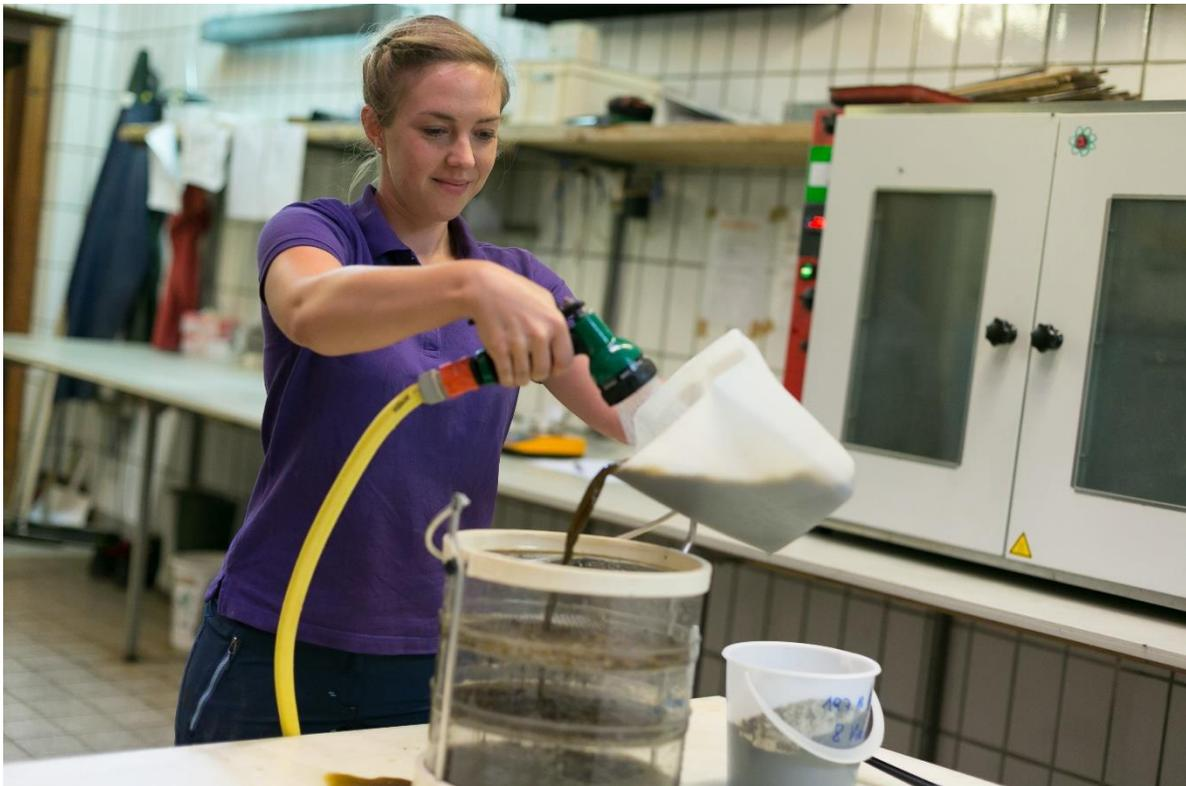
Abbildung 1: Kotsiebung mit Nasco Digestion Analyzer
