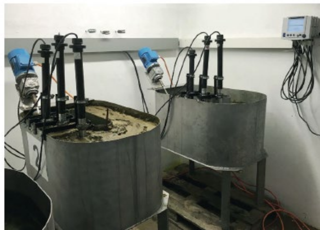
In Versuchsbehältern am Bio-Institut der HBLFA Raumberg-Gumpenstein werden Untersuchungen zur Optimierung der Güllelagerung durchgeführt.
