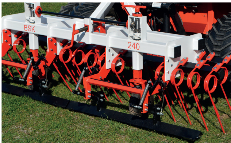
Für optimale Boden-anpassung sind die Tasträder zwischen der Planierschiene und den Zinkenreihen platziert.
