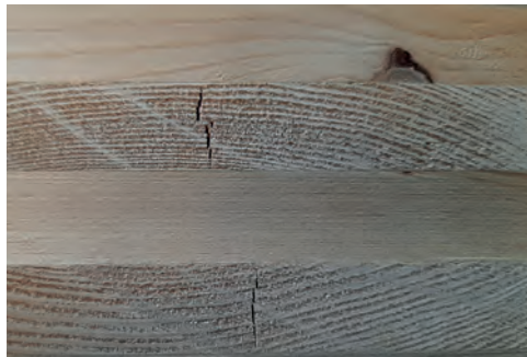
Abbildung 1: Kreuzweise verklebter Aufbau von Brettsperrholz (© Holzplus GmbH)
