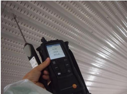
Abbildung 1: Überprüfung einer Zuluftdecke
