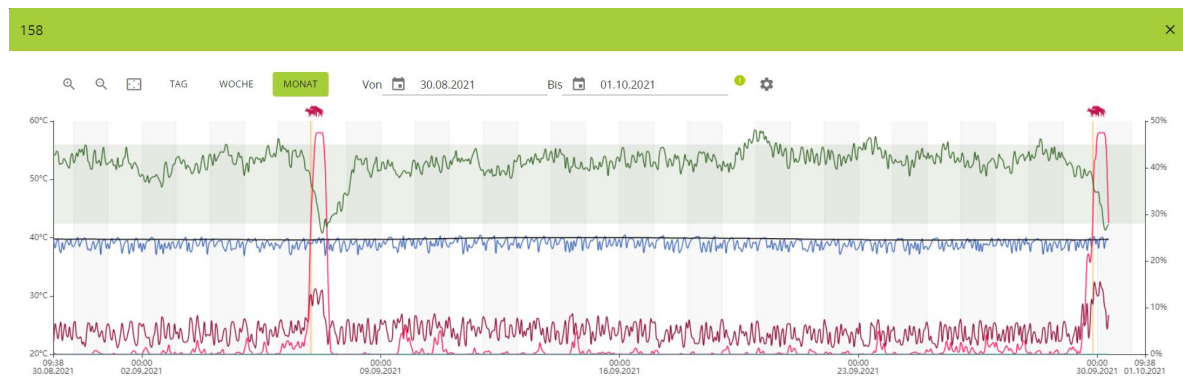
Bild 1: Der Verlauf von physiologisch- und pathologisch relevanten Parametern wird visualisiert und zum Überwachen vom Brunststatus und vom Gesundheitszustand insbesondere am Beginn der Laktation genutzt. Hier eingeblendet sind die Temperatur (blau), die Normaltemperatur (schwarz), die Bewegungsaktivität (dunkelrot), die Wiederkauaktivität (grün), der Brunstindex (pink) und der Abkalbeindex (tyrkis).
