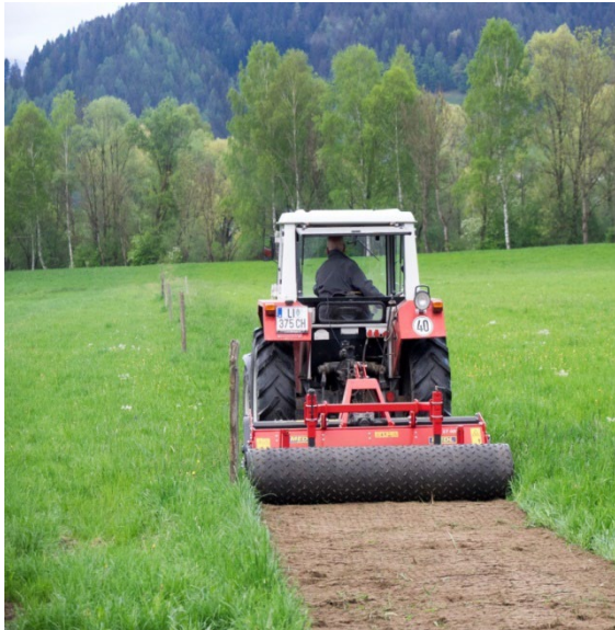
Bild 3: Einsaat einer dauerhaften regionaler Grünland-Saatgutmischung mittels Rotorumkehregge
