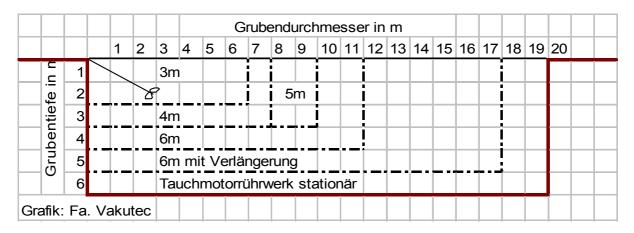
Der Kraftbedarf richtet sich natürlich nach Größe des Rührwerks. Für kleinere Mixer sind vorhandene Kleintraktore von 20 bis 30 kW durchaus ausreichend. Die Mixerlängen variieren zwischen 3 m und 6 m. Mit Verlängerungen und Gelenkmixern sind auch mehr als 8 m möglich.
