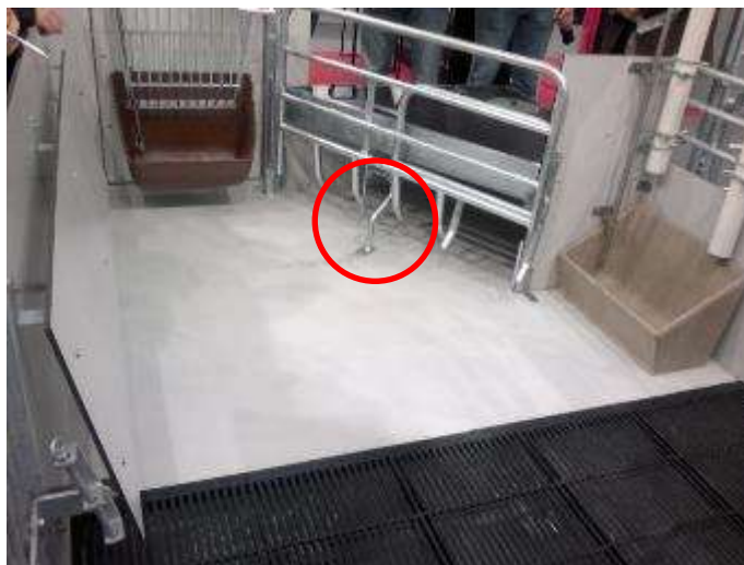
Abbildung 57: In den Bewegungsbereich der Sau hineinragender Stützfuß des geöffneten Abferkelstandes in der SWAP-Bucht, an dem Erdrückungen auftreten können
