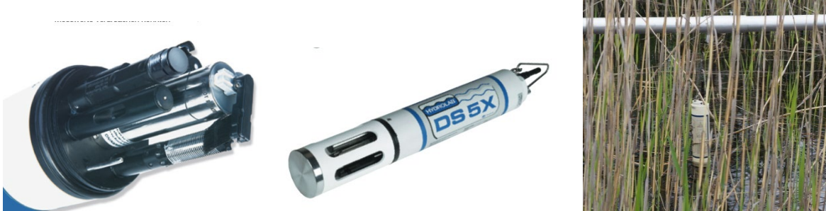
Bild: Multiparametersonde Hydrolab S5 mit Sensoren
