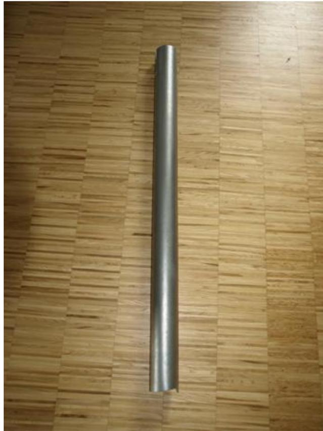
**Abbildung 3: Stechzylinder zur Bestimmung des Schneewasseräquivalents (1 m Länge, 50 cm<sup>2</sup> Oberfläche)**
