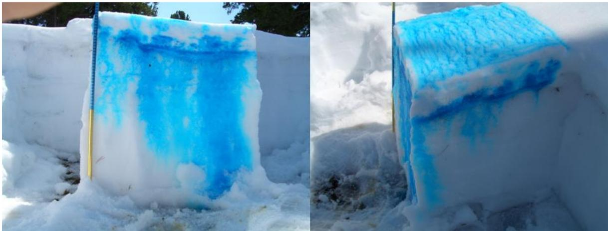
**Abbildung 12: Horizontale und vertikale Verlagerung des Tracers in der Schneedecke nach 5 min**
