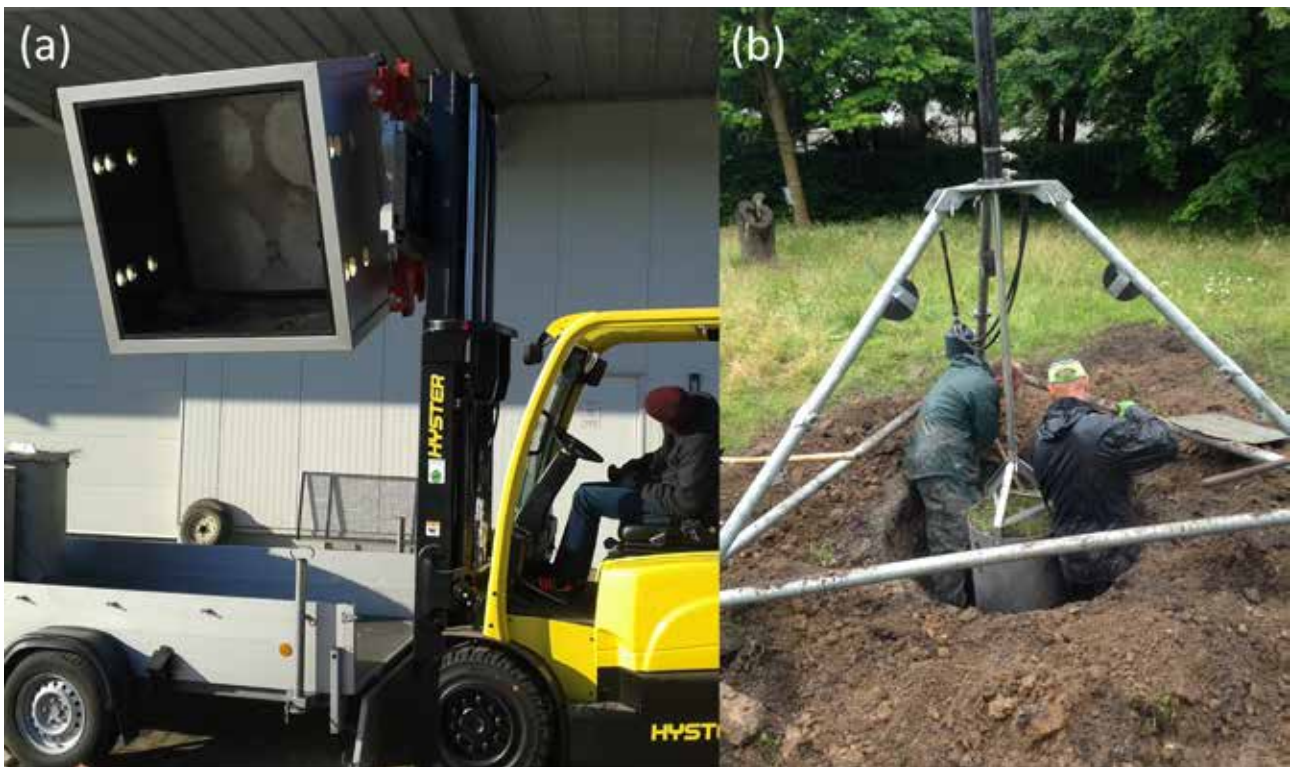
Abbildung 5: Transport und Neigung eines EcoUnit-Bodenteils mit dem Gabelstapler (a) und Entnahme von Lysimetern im Feld durch die UGT GmbH (b).
