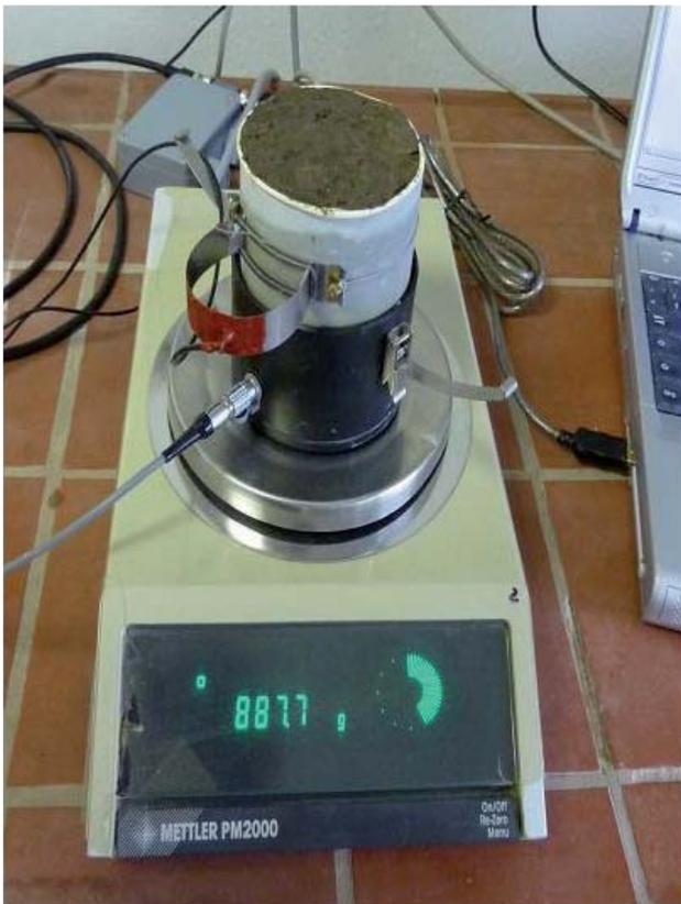
Abbildung 2: HYPROP System gekoppelt mit dem Umfangsmeter
