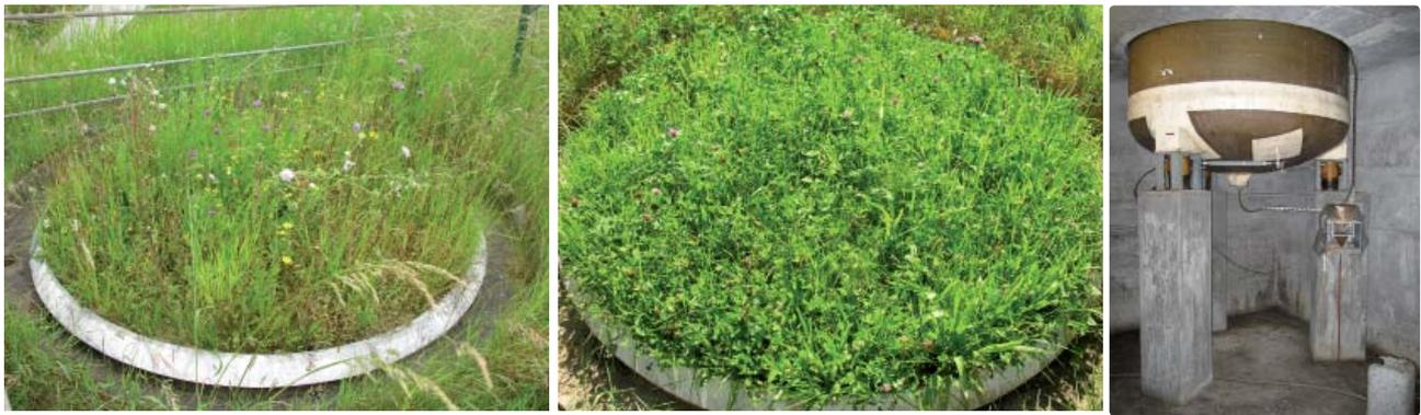
Abbildung 1: Lysimeter mit extensiv genutzter Wiese (links) und intensiv genutzter Wiese (Mitte) sowie Lysimeterkeller mit Kippwaage für die Sickerwassermessung (rechts).
