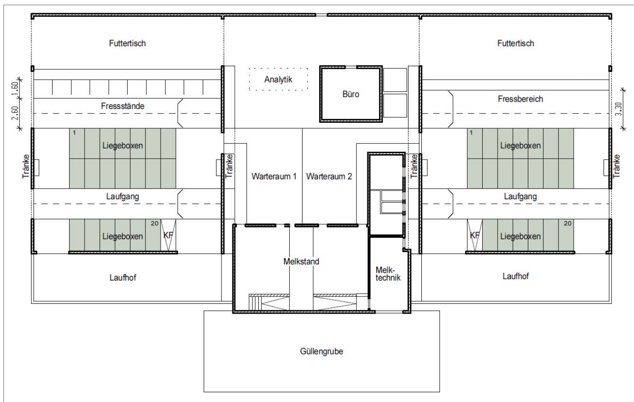
Abbildung 1: Schematischer Grundriss des Emissionsversuchsstalls mit den Versuchsabteilen Minderungsvariante (links) und Referenzvariante (rechts) sowie dem Zwischenbereich.
