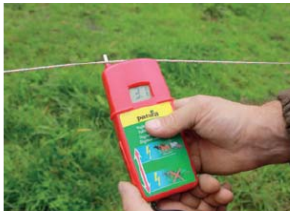
aunspannung mit simulierter Tierberührung.
